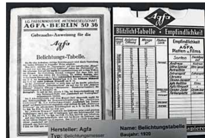
Belichtungstabelle von Agfa, 1920, manuell konnte man mit Schiebern verschiedene Belichtungen ablesen und auf die Kamera übertragen.
