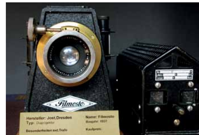
Diaprojektor von 1935, gebaut von Fa. Jost, Dresden. Mit dem dicken Drehwiderstand rechts kann man die Helligkeit der Bilder regeln.
