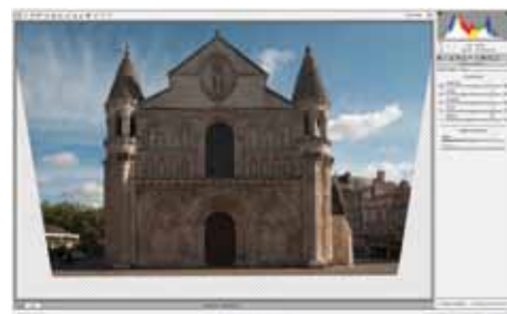
Tonnenförmige Verzerrung und Randabschattung – charakteristische Abbildungsfehler des hier verwendeten Fisheye.
